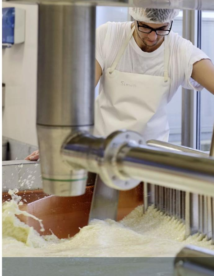
Zur weiteren Verarbeitung werden die Käseflocken inklusive Molke in große runde Formen gepumpt und anschließend gepresst
